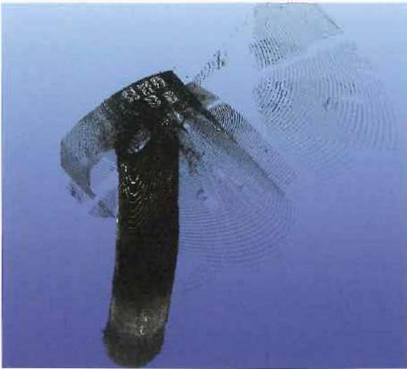
9 Brunnenröhre einschl. des darüber befindlichen Gewölbes als sog. Punktwolke in isometrischer Darstellung (dargestellt mit der Software „lupoScan“)
