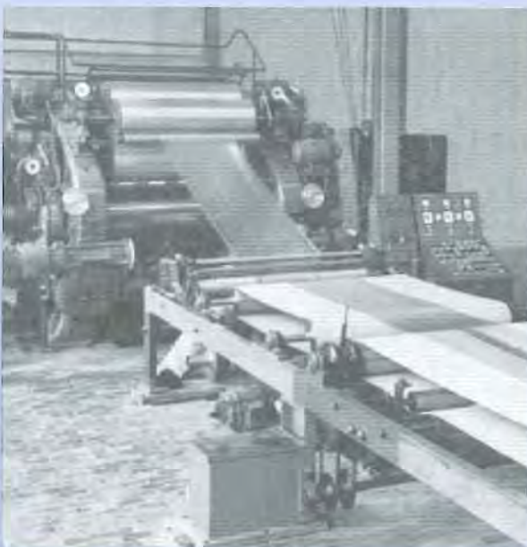
Kalandriermaschine für PVC-Folien
